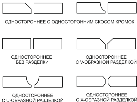
Рис. 6 Виды стыковых соединений
