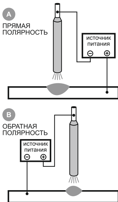
Рис. 3. Места установки сварочных кабелей
