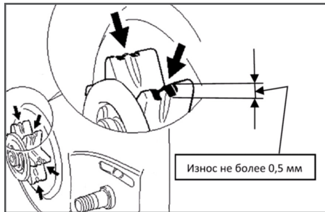
Рис. 14 Проверка износа звездочки
