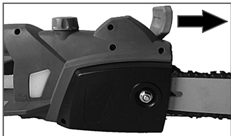
Рис. 8 Включение тормоза цепи
